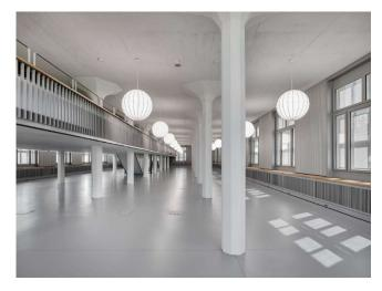
Für den Umbau war der Industriebau vollständig entkernt worden. Aufgrund des Denkmalschutzes musste die Fabrikfassade von innen saniert werden. Um die einzigartige
